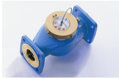
Mehrstrahlflügelradzähler, Trockenläufer, Typ MTK, Qn 15 mit Impulsausgang
